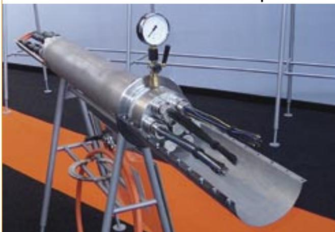
Герметичная кабельная проходка для PGKK - KABEX 2002.
