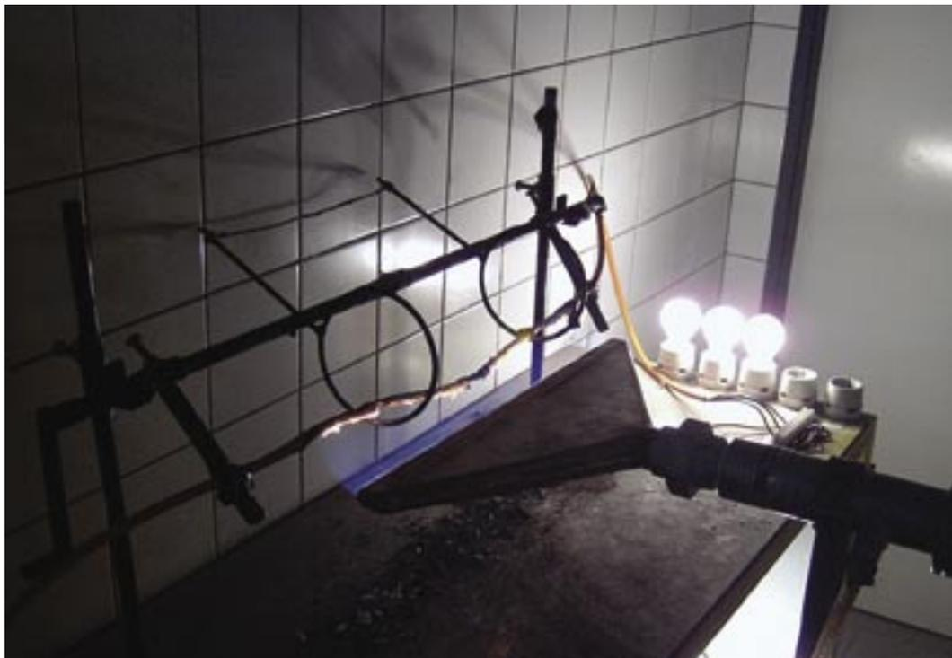
Согласно ČSN IEC 60331 - испытание на изоляционную целостность.
