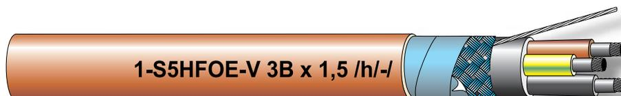
Нераспространяющий горение и огнеупорный кабель, экранированный оплеткой с оцинкованным проводом против воздействия электромагнитного поля.
