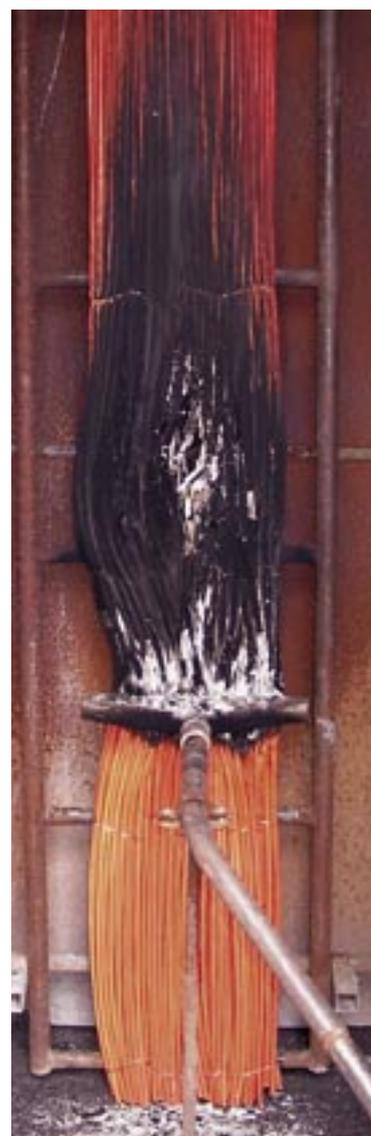
Согласно ČSN EN 50266 - испытания нераспространяющих горение кабелей и проводников.
