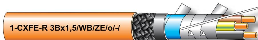
Нераспространяющий горение и огнеупорный кабель, экранированный против воздействия электромагнитного поля, снабженный механической защитой от повреждения и барьером против продольного просачивания жидкостей в кабель.
