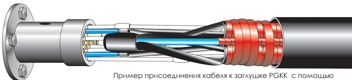
Пример присоединения кабеля к заглушке ПГКК с помощью квалифицированного кабельного комплекта
